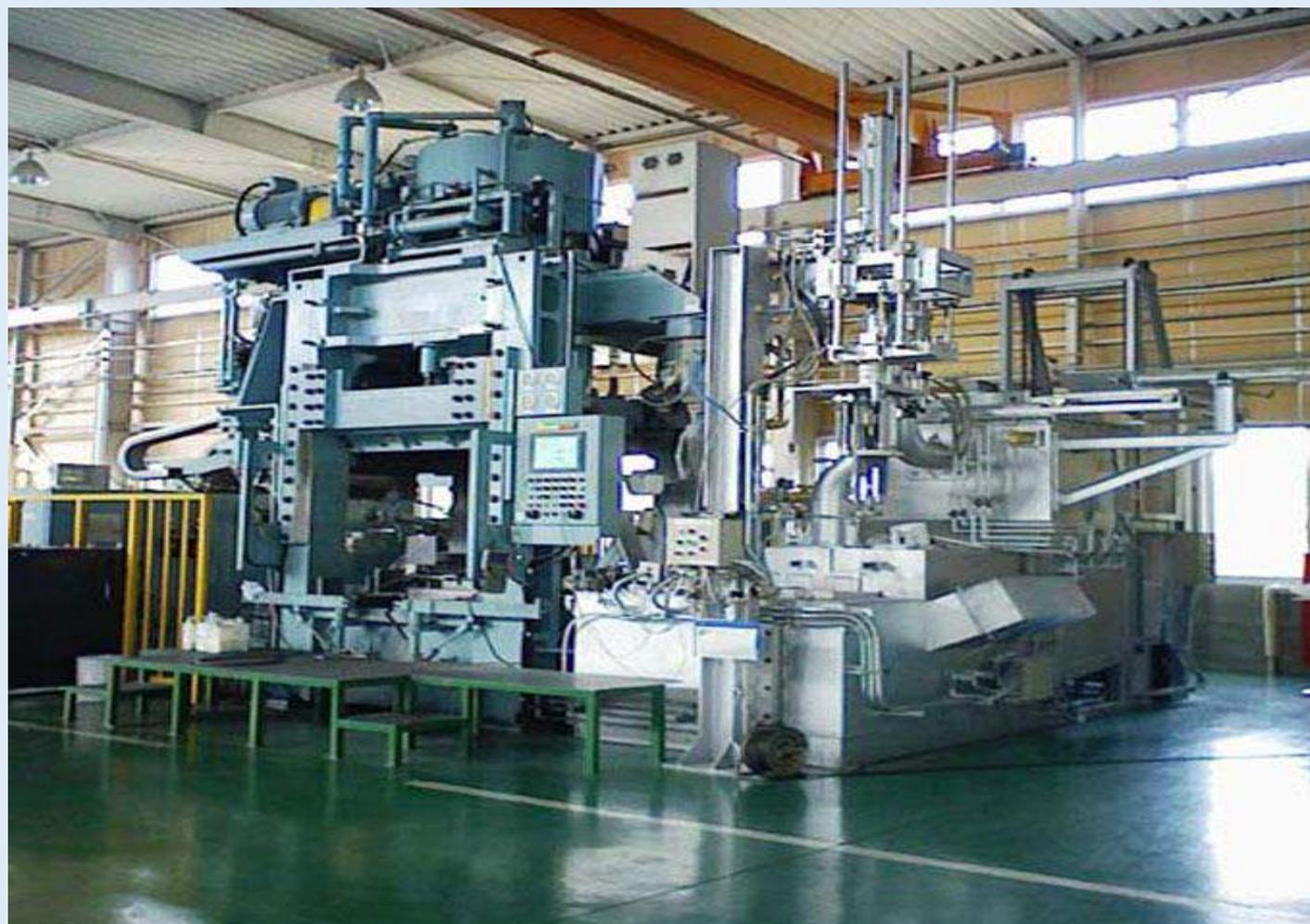
500TON RECアルミ鑄造装置
