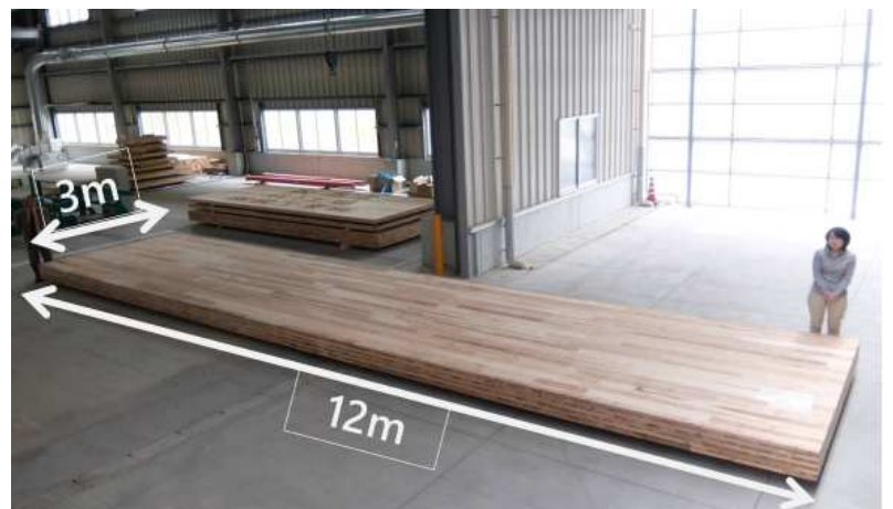
(右) CLT(Cross Laminated Timber: 直交集成板)の利点 国産材活用 / 工期短縮 / 高い断熱・耐火・耐震性 / 中高層木造建築の実現
