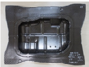
CFRTTPによるオイルパンのプレス成形
