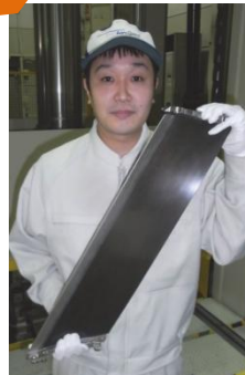
「PW1100G-JM」用の複合材構造案内翼 (SGV) (IHI 資料)
