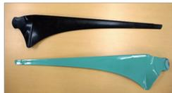
CFRTP による風力発電用ブレード
