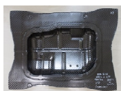
CFRTP によるオイルパンのプレス成形
